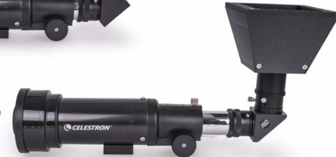
Unten: Der selbe Aufbau, aber nun ist der OPFA mit dem T-2-Prisma #2456005 direkt verschraubt. So lässt er sich auch an Teleskopen mit weniger Backfokus nutzen. Die Fotos zeigen die 3D-gedruckte Box; die .stl-Dateien finden Sie unter baader-planetarium.com/bsps
