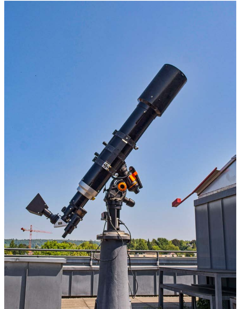
Der Solar Projection Screen an einem 150/1200-Refraktor mit dem 3D-gedruckten Projektionsgehäuse. Anmerkung: Das Sucherfernrohr ist vorn mit einem Objektivdeckel sicher verschlossen.
