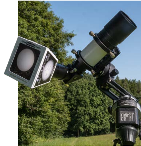
Baader VarioFinder 60/250, mit 6mm Classic Ortho auf leichter Reisemontierung. OPFA wegen Backfokus direkt am Zenitprisma #2456005 verschraubt.
