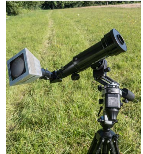
Celestron TravelScope, mit 18mm Classic Ortho auf leichter Reisemontierung, abgeblendet. OPFA an 1/4" Zenitspiegel
