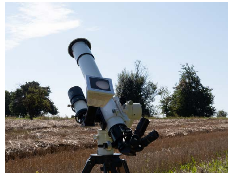
Sonnenbeobachtung mit einem Refraktor mit ASTF-Frontfilter auf einer mobilen Montierung. Der Solar Projection Screen am VarioFinder dient hier zur Nachführkontrolle z. B. bei öffentlichen Beobachtungen.
