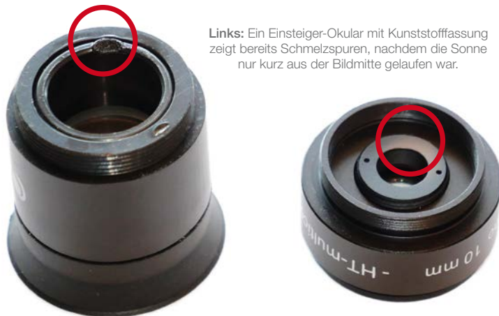
Rechts: Ein 10mm Classic Ortho, das längere Zeit nicht exakt auf die Sonne gerichtet war. Lediglich die Eloxierung der ersten Metall-Schutzblende ist ausgeblüht, das Okular selbst ist unbeschädigt. Solange die Nachführung korrekt funktioniert, passiert auch der Eloxierung nichts. Beide Bilder zeigen die Okulare ohne 1¼" Steckhülse.
