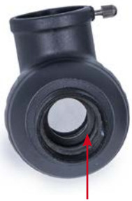
Zenitprisma mit unterdimensioniertem Prisma und sichtbarer Kunststoff-Fassung. Diese Bauart ist für die Sonnenprojektion ungeeignet.
