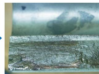
Illumination d'une fracture de surface (métal) avec les zones d'éclairage supérieures de la source de lumière annulaire
