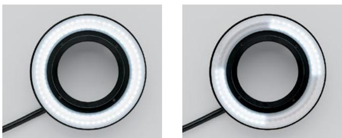
Le contrôle exclusif du dispositif d'illumination annulaire à LED permet aux utilisateurs de choisir l'éclairage LED souhaité parmi les 13 dispositions d'éclairage possibles, et ce, afin de profiter de conditions d'observation optimales. Il est possible de passer d'une disposition d'éclairage 3/4, 1/2 et 1/4 à une autre en appuyant sur les boutons de rotation et de miroir de l'unité de commande. Le design ergonomique de l'unité est parfaitement adapté à une utilisation manuelle.
