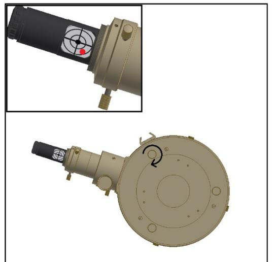
Figura 4. Inserire il collimatore del laser nel tubo del focheggiatore. Assicurarsi di averlo stretto come se si trattasse di un oculare.
