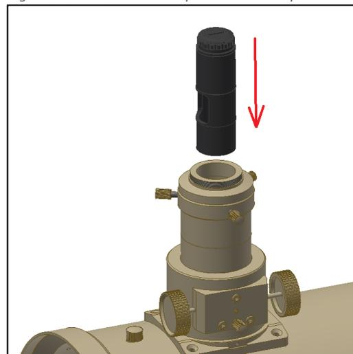
Figure 3. Insérez le laser de collimation dans le tube du porte-oculaire. Assurez-vous de le serrer comme si c'était un oculaire.
