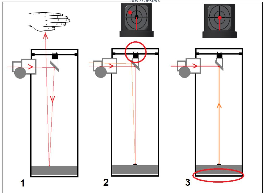
Figure 7. #1 – Télescope extrêmement désaligné ; #2 – Les vis de réglage du miroir secondaire sont utilisées pour orienter le faisceau principal vers le centre du cercle du miroir primaire ; #3 – Les vis de réglage du miroir primaire sont utilisées pour orienter le faisceau réfléchi vers le miroir secondaire.
