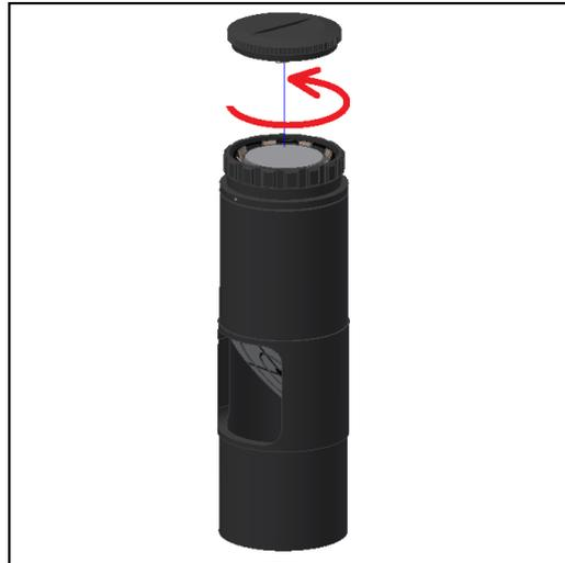
Figura 1. Saque la tapa para ver la pila.
