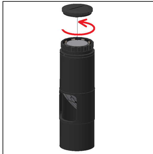
Abb 1. Die Batteriekappe entfernen.
