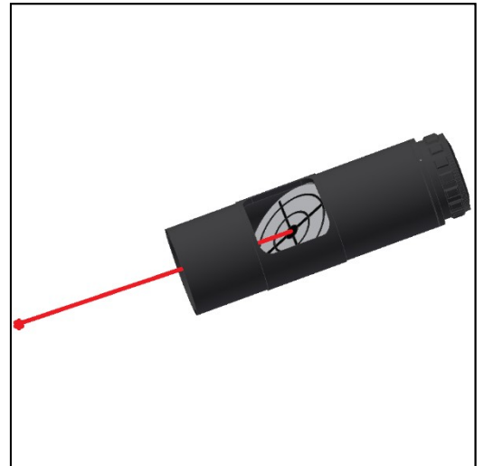
Abb 2. Das Oberteil drehen, um den Laser einzuschalten.
