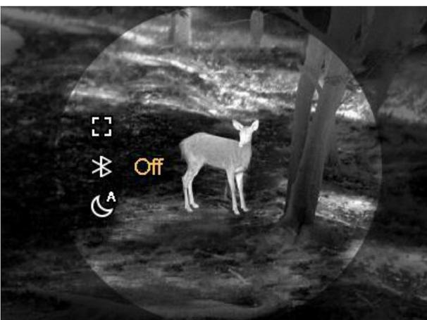
Die Verbindungsdistanz zwischen dem Wärmebild-Vorsatzgerät und der Bluetooth-Quelle ist max. 3 m. Innerhalb dieser Entfernung passt sich das Gerät vorzugsweise an die zuletzt verwendete Bluetooth-Quelle und stellt eine Verbindung her. Beim Einschalten der Bluetooth Funktion, erscheint auf dem Bildschirm die Meldung „**Bluetooth is searching...**“ (Suche nach Bluetooth-Verbindung) und danach ein Bluetooth Symbol beginnt zu flackern.
