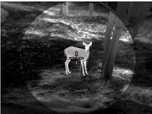
Wenn die Wärmeverfolgung eingeschaltet ist, wird der Punkt mit der höchsten Temperatur im Bild mit einem gelben Cursor angezeigt.
