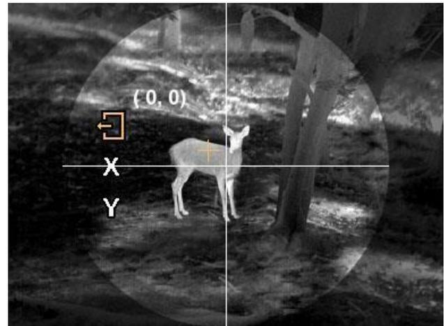
2. Mit der Taste AUF oder AB können Sie die Achse X oder Y zur Bildjustierung auswählen.
