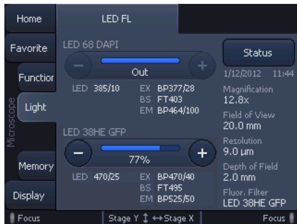
Bild 34 Ansicht mit zwei installierten LED-Zwischentuben S
