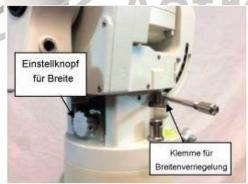
Drehen Sie den Breitengrad-Einstellknopf, bis der Pfeil auf Ihren aktuellen Breitengrad auf der Breitengradskala zeigt. Ziehen Sie die Latitude Verriegelungsklammer fest, wenn Sie fertig sind.
