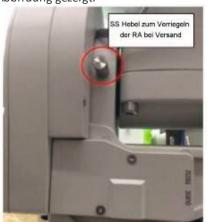
Entfernen Sie es vom RA-Joch, damit die Halterung frei in der RA-Achse schwenken kann. Stellen Sie sicher, dass der RA-Gangschalter eingerastet ist, bevor Sie den SS-Hebel entfernen. Benutze es um alle Schrauben / Muttern festzuziehen. Fädeln Sie es in das Loch unter der Hauptplatine.
