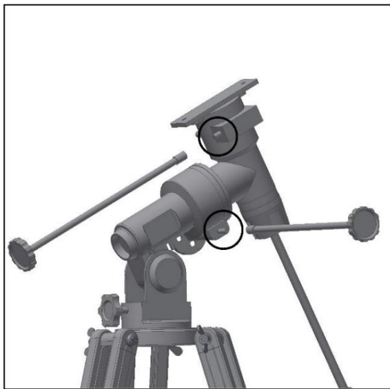
Figura 6. Posizionare le manopole.
