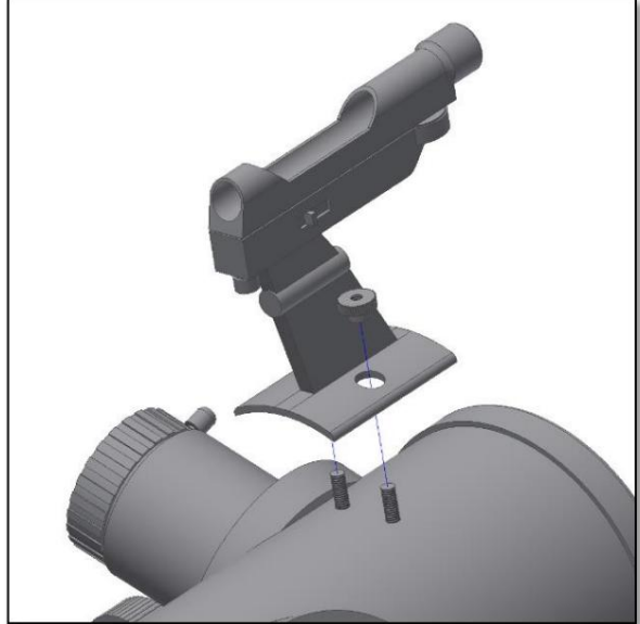
Figura 11. Posizionare il cercatore e avvitare i dadi a testa zigrinata
