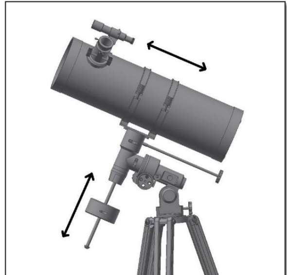
Figura 13. Bilanciare gli assi di entrambi i telescopi.
