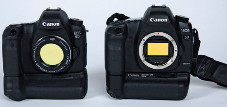
▲ Abb. 5: Adapter für den Filtereinsatz: Gerd Neumanns »Clip-Filter« (rechts) und Baaders »Protective T-Ring« (links).
