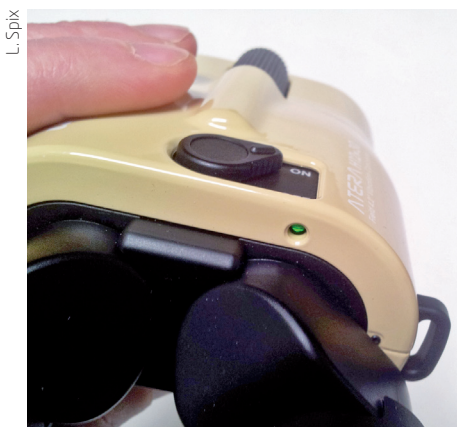
▲ Abb. 3: Eine grüne LED zeigt das Arbeiten der Bildstabilisation an.
