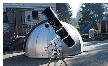
▲ Abb. 2: Die EQ6-R im fotografischen Einsatz mit einem 10 Zoll f/4.7 Newton mit einem Gesamtgewicht von 18kg.
