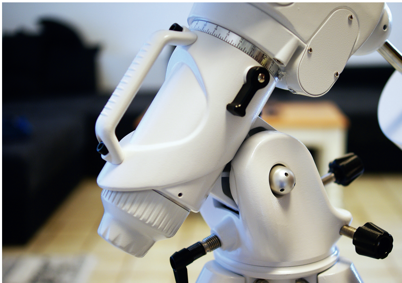
▲ Abb. 4: Der Tragegriff erweist sich als äußerst praktisch, kann aber bei Bedarf abgebaut werden.
