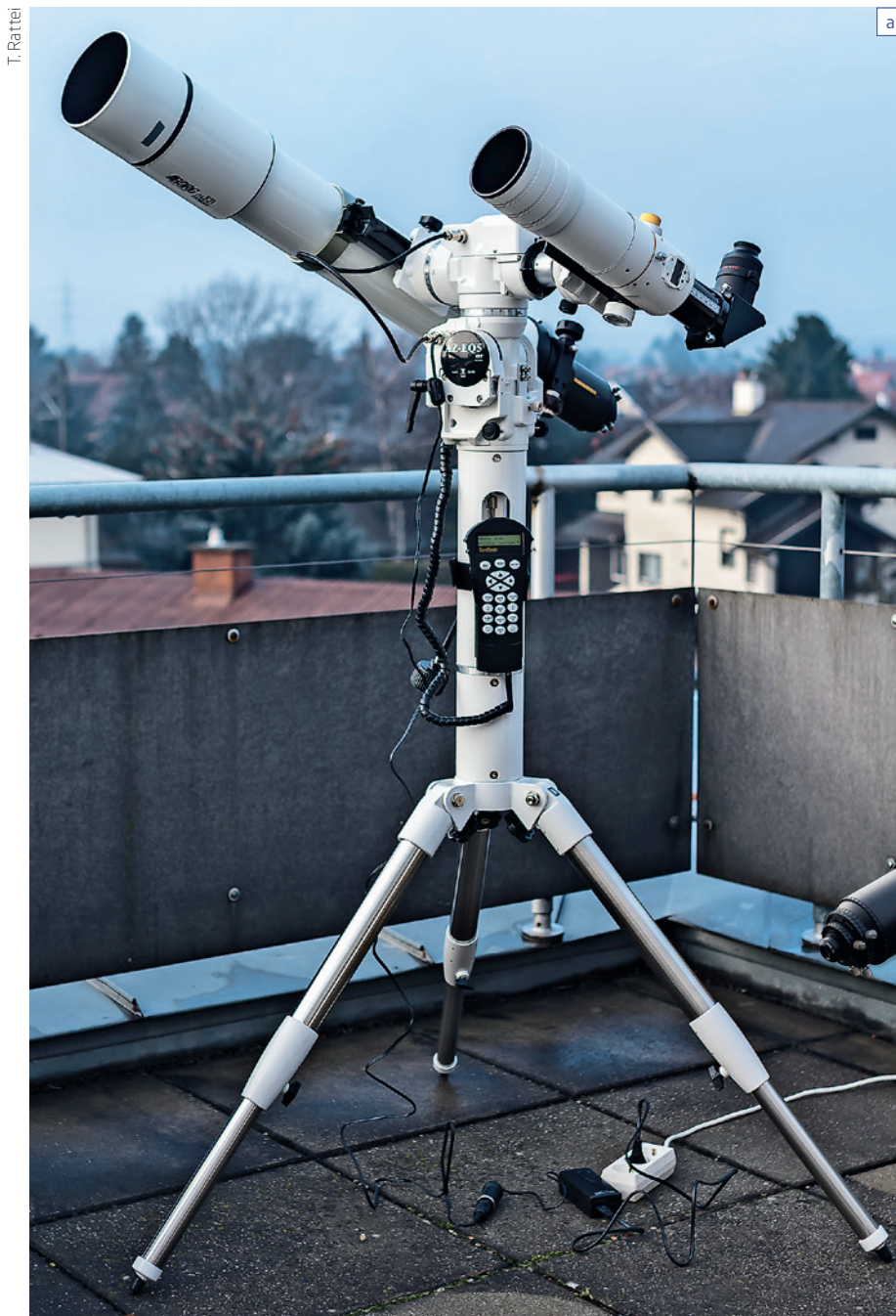
◀ Abb. 1: Die Sky-Watcher AZ-EQ5 GT kann im azimutalen (a) oder parallaktischen (b) Modus betrieben werden.
