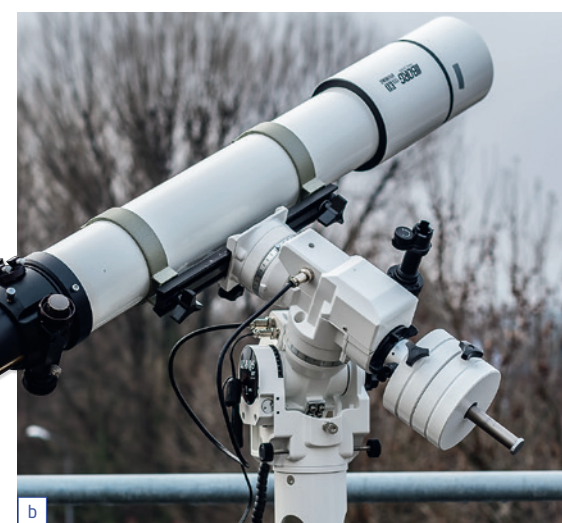
◀ Abb. 1: Die Sky-Watcher AZ-EQ5 GT kann im azimutalen (a) oder parallaktischen (b) Modus betrieben werden.
