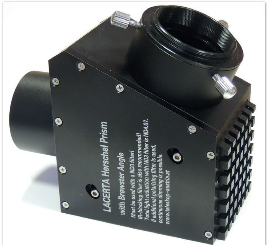
▲ Abb. 1: Das Lacerta-Herschelprisma besitzt einen Ablenkungswinkel von 101,6°, um die vollständige Polarisation des Sonnenlichts zu erreichen.
