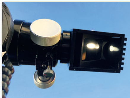
▲ Abb. 3: Das 2-Zoll-Herschelprisma am Teleskop mit zum Kühlkörper abgeleiteten überschüssigem Sonnenlicht.
