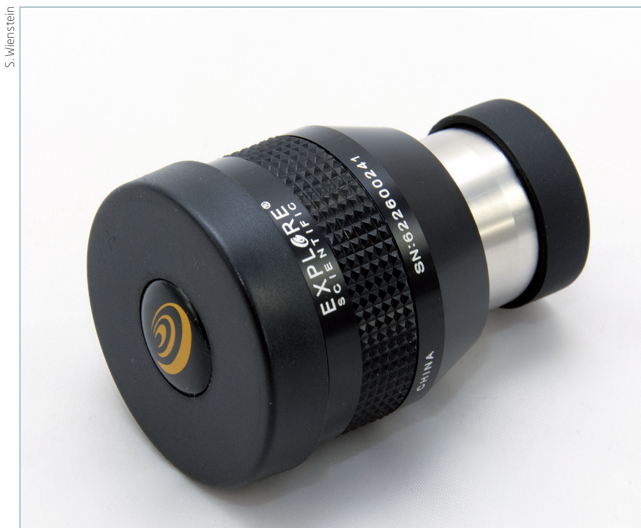
▲ Abb. 5: Die Kappe sitzt nur richtig, wenn die Augenmuschel umgeklappt ist.
