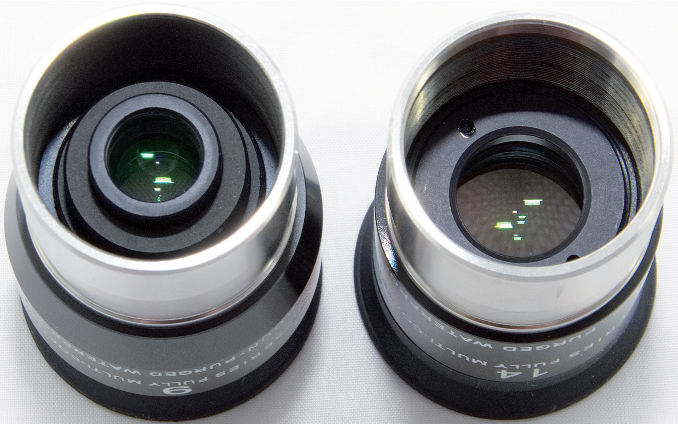
▲ Abb. 3: Das 9mm (links) hat ein Negativ-Element vor der Feldblende, während sich beim 14mm die Feldblende vor der ersten Linse befindet.
