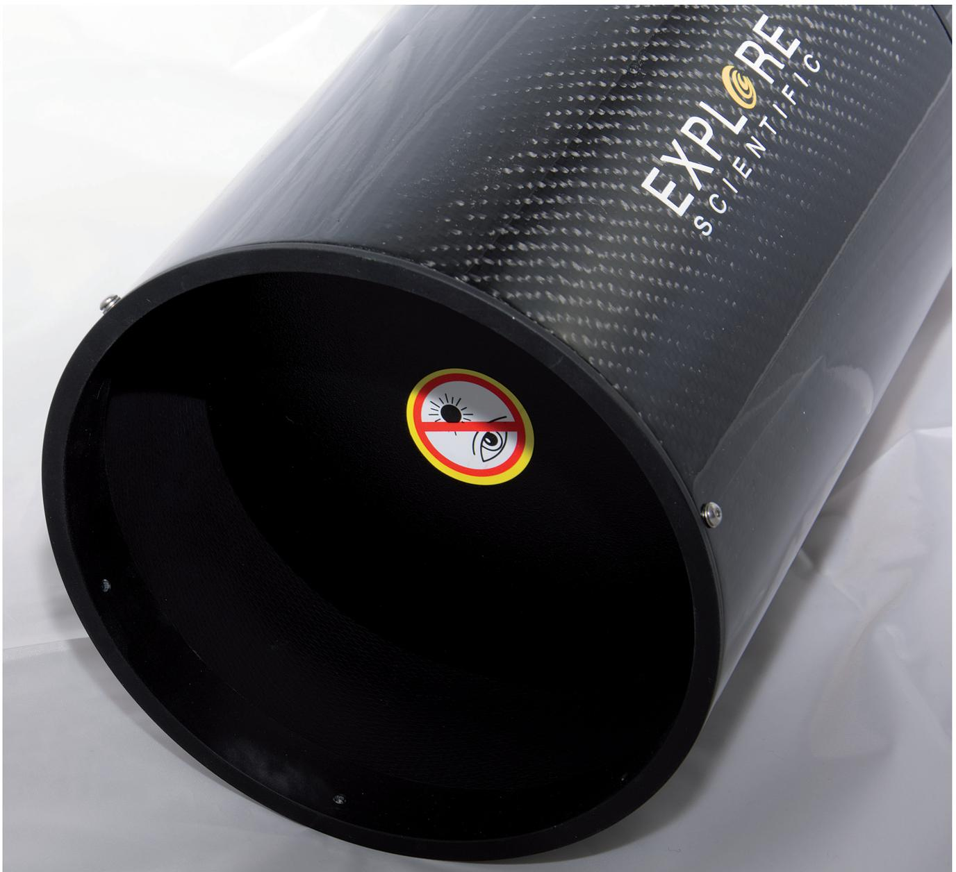
▲ Abb. 4: Kann aufgrund der Rohrschellenposition die Taukappe nicht eingeschoben werden, ist der Deckel nur schwer abzunehmen.
