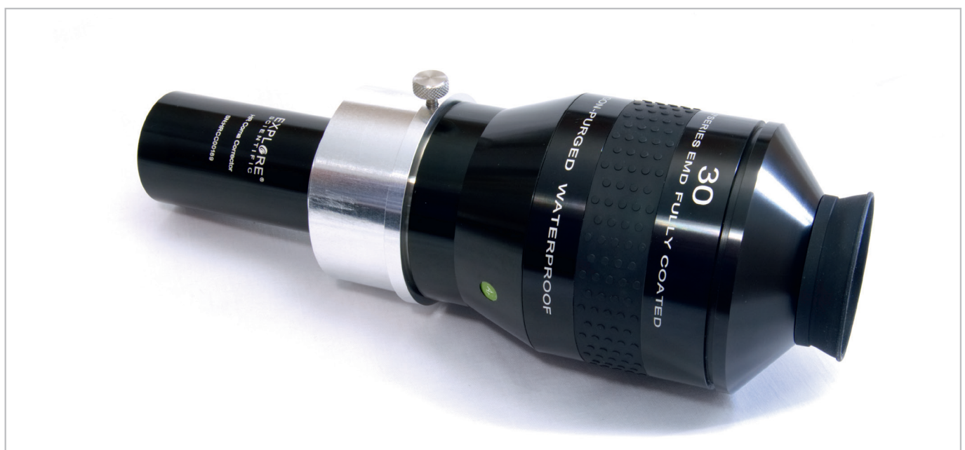
▲ Abb. 2: Mit einem eigens angefertigten Adapter kam das Okular mit dem HRCC Komakorrektor am schnellen Newton zum Einsatz.
