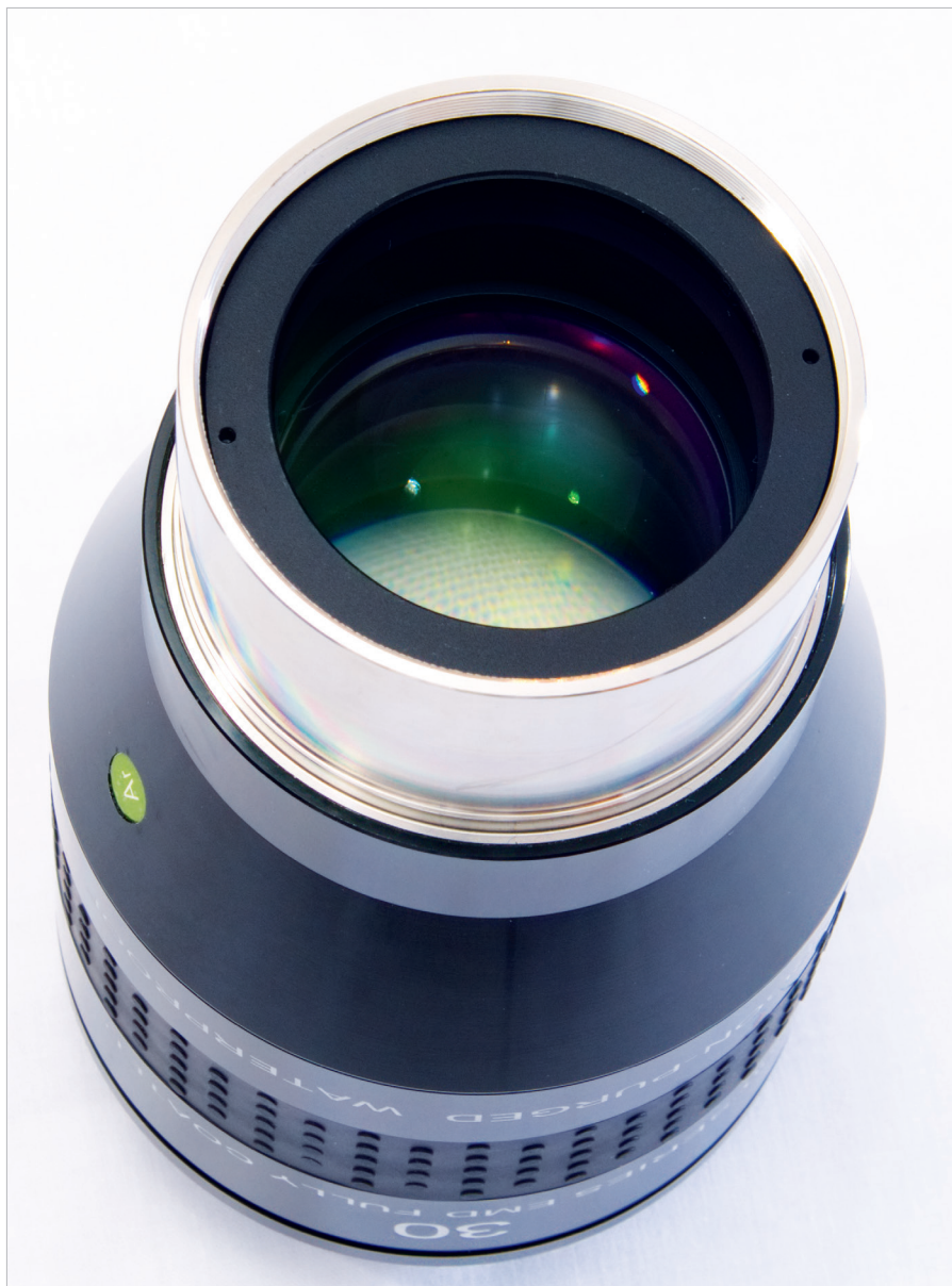
▲ Abb. 3: Die teleskopseitige Linse erlaubt den Blick auf gut ausgeführte Schwärzungen und zeigt hochwertige Mehrschicht-Vergütungen. Sie ist aber nicht viel größer als der freie Durchmesser einer 2-Zoll-Steckhülse.
