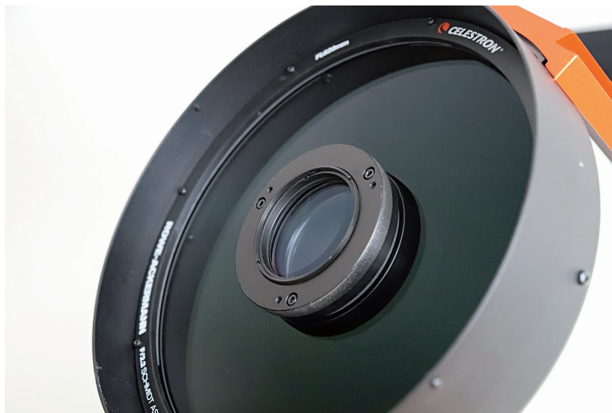
▲ Abb. 7: Deutlich sind der in der Schmidt-Platte sitzende Korrektor und das ihn umgebende Gewinde zu erkennen, an dem verschiedene Kameras beispielsweise über T2- und/oder M48-Adapter angeschlossen werden können.
