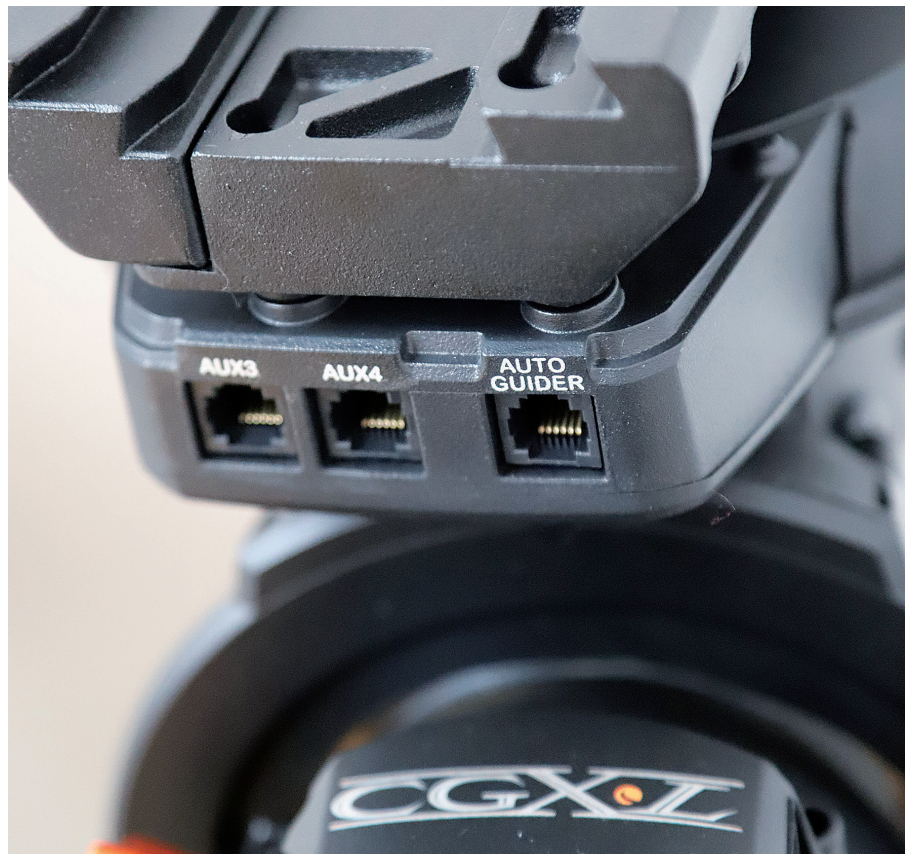
▲ Abb. 5: Die innen verlegten Kabel und die verschiedenen Schnittstellen helfen, Kabelbrüche und versehentliches Hängenbleiben zu vermeiden.
