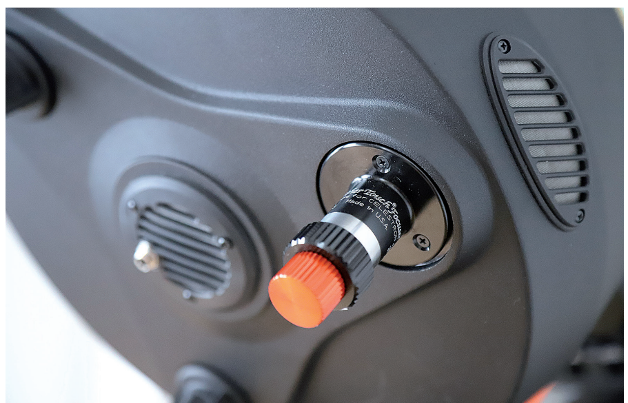
▲ Abb. 6: Die exakte Fokussierung des RASA erfolgt mittels eines – farblich passenden – FeatherTouch Mikro-Fokussierers.
