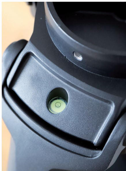
▲ Abb. 3: Es sind Details, wie beispielsweise die ins Stativ integrierte Wasserwaage, die den nächtlichen Einsatz der Montierung vereinfachen.
