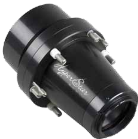
Die HyperStar-Optik wird an der Frontseite des C11 Edge HD montiert. Auf diese Weise entsteht aus dem Schmidt-Cassegrain-Teleskop mit dem Öffnungsverhältnis f/10 eine lichtstarke Schmidt-Kamera mit f/2 .
