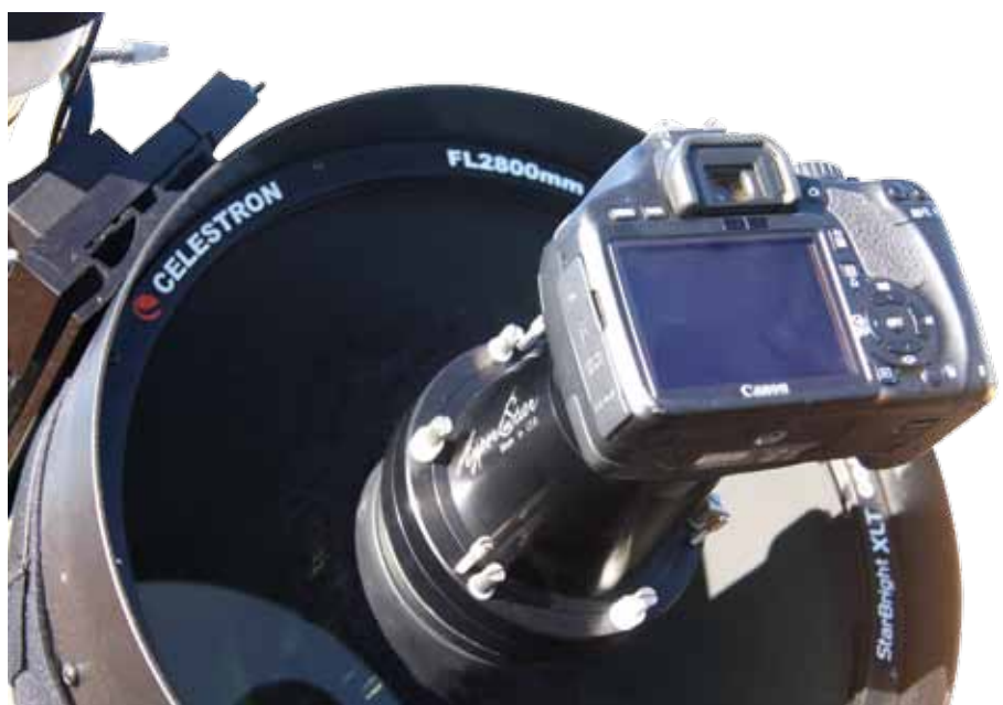
Die HyperStar-Optik wird an der Frontseite des C11 Edge HD montiert. Auf diese Weise entsteht aus dem Schmidt-Cassegrain-Teleskop mit dem Öffnungsverhältnis f/10 eine lichtstarke Schmidt-Kamera mit f/2 .
