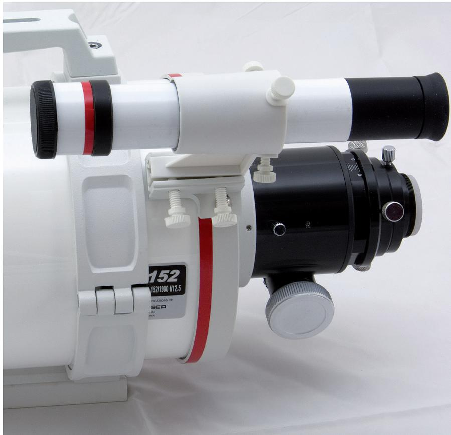
▲ Abb. 4: Der Schwerpunkt liegt weit hinten, so dass die Rohrschelle über das Typenschild geschoben werden muss. Der Sucher ist dann nicht mehr reibungslos abzunehmen.
