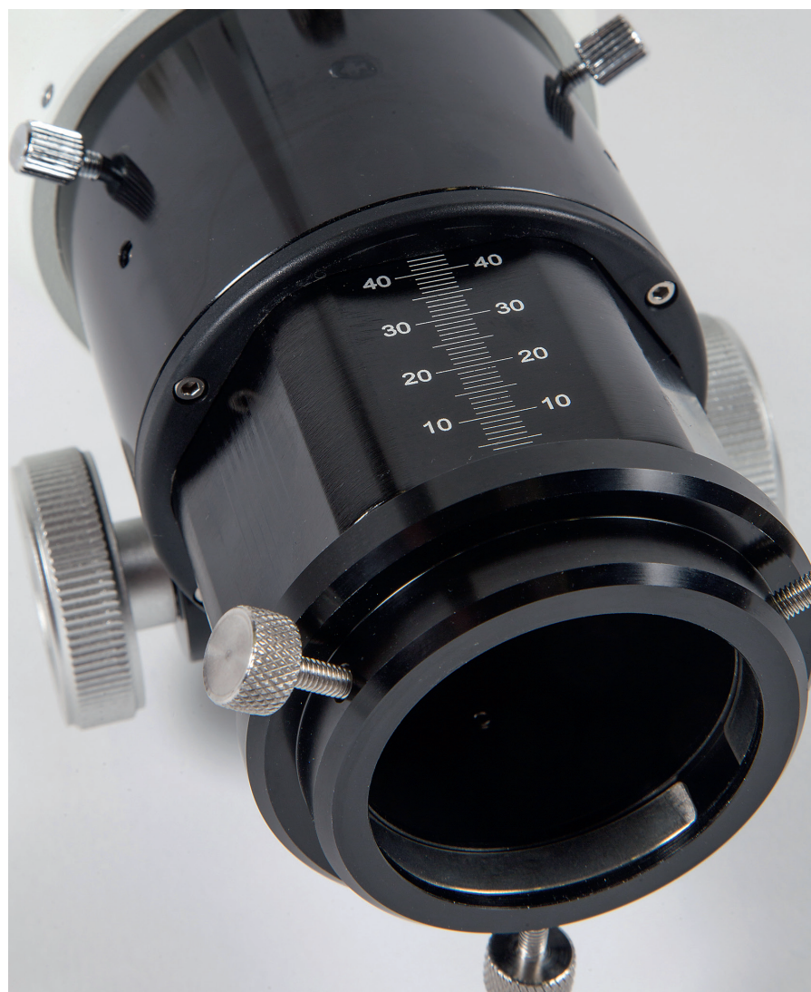
▲ Abb. 3: Der wertige Metall-Auszug verfügt über 40mm Fokusweg und eine entsprechende Millimeterskala, jedoch keinen unteretzten Feinfokus. Hier ist der 2-Zoll-Okularadapter am Ende des Auszugs montiert, um beispielsweise eine Kamera aufnehmen zu können.
