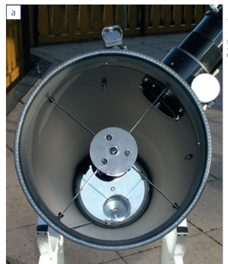
Abb. 3: Der Blick auf den Tubus von vorne (a) und hinten (b) zeigt die Fangspiegel-Aufhängung und die Justierschrauben.
