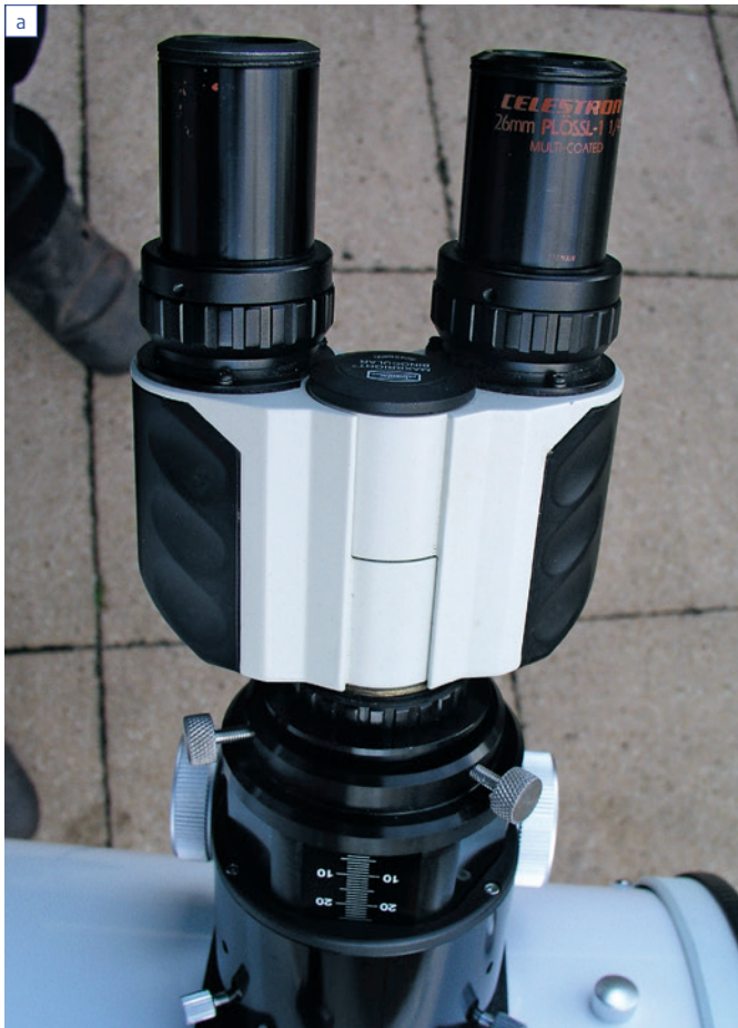
Abb. 2: Für die monokulare Beobachtung muss die Verlängerungshülse verwendet (a), für die binokulare Verwendung entfernt werden (b).
