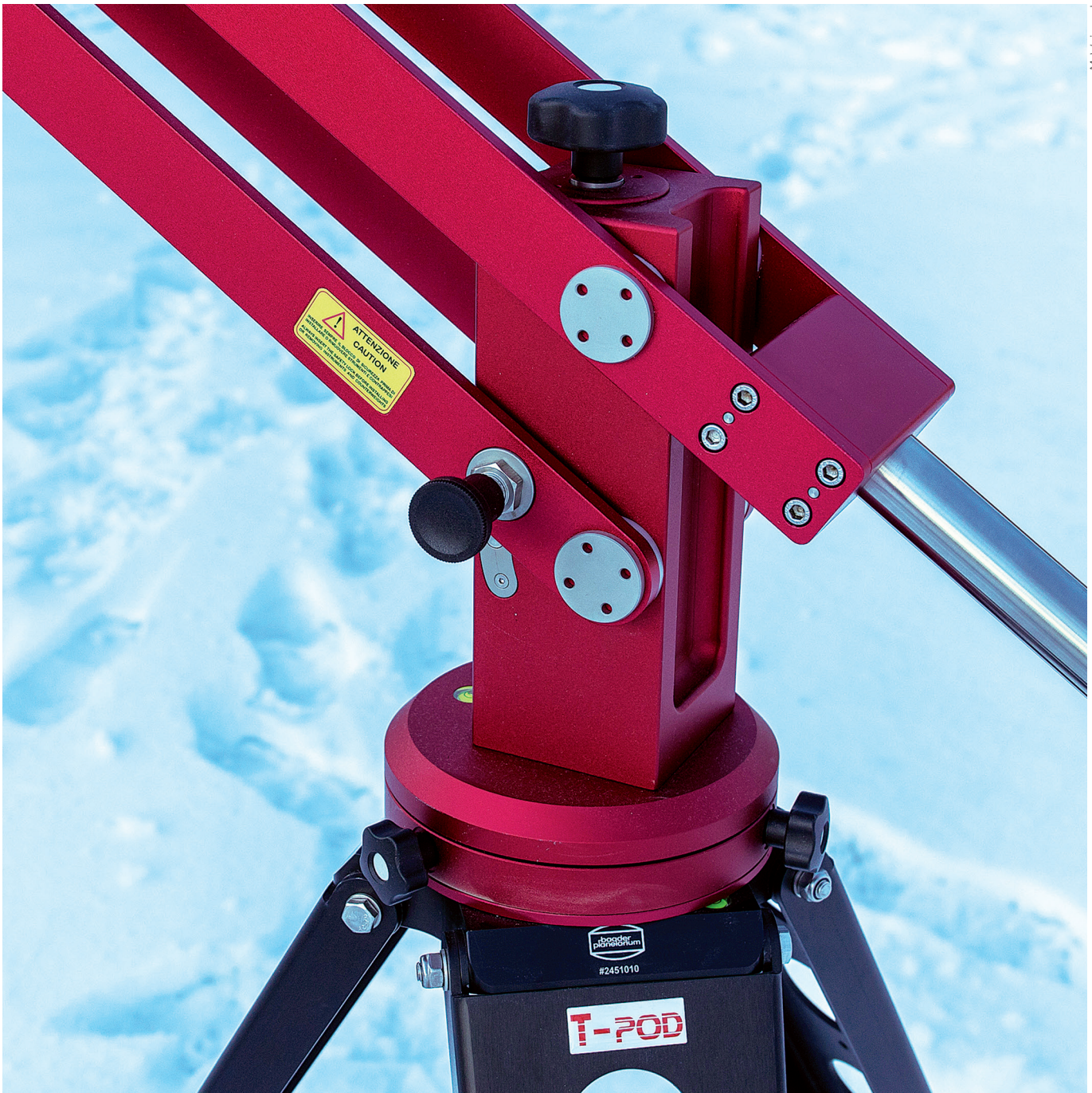
▲ Abb. 3: Die Basis der Montierung mit der Friktionseinstellung (große Sterngriffschraube) für die Azimut-Achse an der Oberseite. Beim Ändern der Friktion verstellt sich die Ausrichtung der Montierung nicht.
