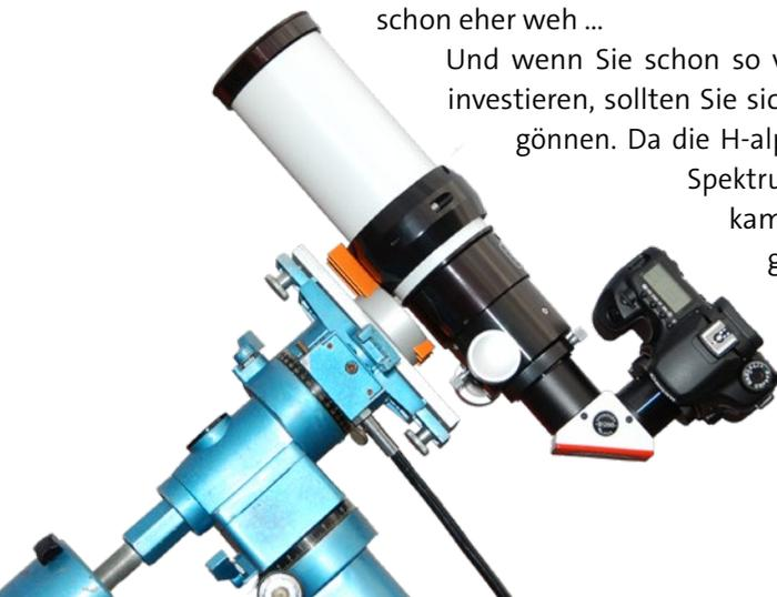
erlaubt wesentlich kürzere Belichtungszeiten, und Sie können die Bilder immer noch später in Photoshop rot einfärben. Da es hier um Details geht, werden immer Videosequenzen aufgenommen und gestackt – und aufgrund der starken Helligkeitsunterschiede sind für Oberfläche und Protuberanzen unterschiedliche Belichtungszeiten nötig, es werden also immer zwei unterschiedliche Aufnahmen gestackt, wenn Sie beides sehen.
