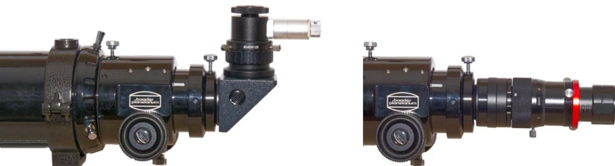
*Kamera und Okular haben unterschiedliche Fokusslagen. Links ein Fadenkreuzokular mit Zenitspiegel, um den Planeten zu zentrieren, rechts eine Planetenkamera mit diversen Verlängerungshülsen und einem Helikalfokussierer, damit ohne Nachfokussieren zwischen Okular und Kamera gewechselt werden kann. Der Kamerasensor befindet sich etwa auf derselben Höhe wie der rote Feststellring.*
