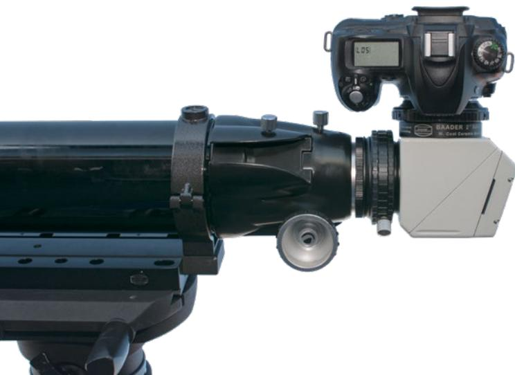
*Beim Anschluss einer DSLR an einen Herschelkeil muss meist der Okularstutzen entfernt werden.*
