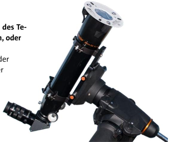
*Ein Folien-Sonnenfilter vor dem Objektiv bietet Schutz. Die ASTF-Filterfassungen von Baader Planetarium sind temperaturkompensierend, damit die Folie auch bei langen Beobachtungszeiten nicht unter Spannung gerät und der Kontrast nicht einbricht.*
