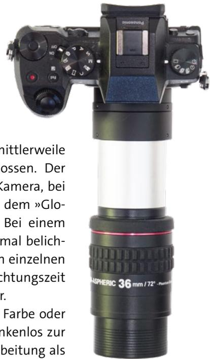
*Mit der Okularprojektion lassen sich extrem hohe Vergrößerungen erzielen, vor allem wenn der Abstand zum Okular durch Verlängerungshülsen erhöht wird. Meist genügt aber eine Barlowlinse.*
