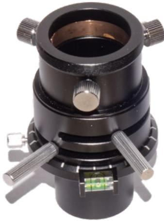
*Ein Atmospheric Dispersion Corrector, kurz ADC, besteht aus zwei gegeneinander beweglichen Prismen und gleicht die Farbausplattung durch die Erdatmosphäre aus. Bei dem Modell links werden die Prismen mit zwei Hebeln eingestellt, bei dem rechten komfortabel mit einer Schraube.*
