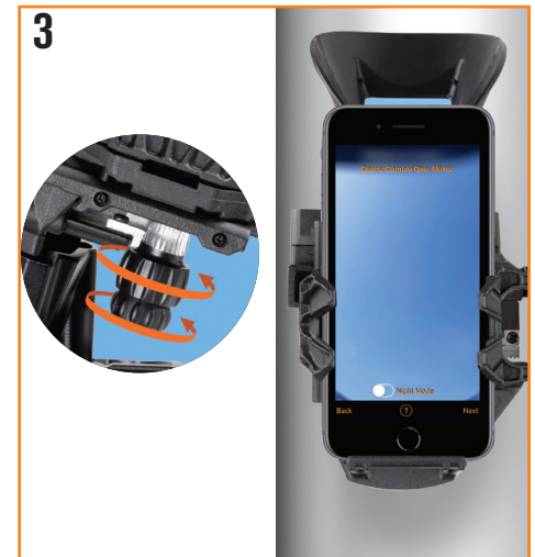
3. Ensuite, vous allez centrer votre téléphone sur le miroir du StarSense Dock. Faites tourner les molettes sur le bas du support jusqu'à ce que la vue de votre caméra soit centrée et complète dans le miroir.
