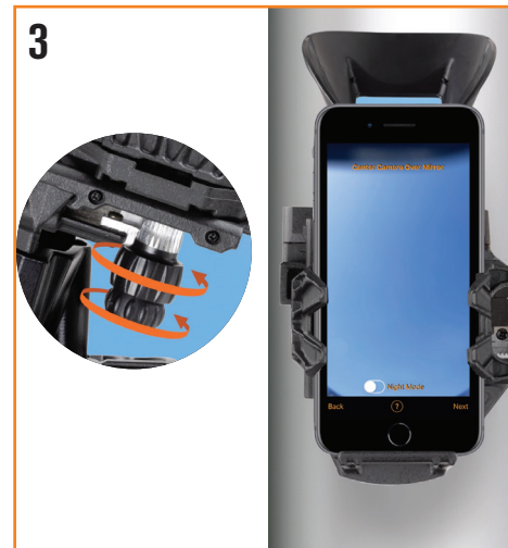
3. Successivamente, centrare il telefono sullo specchio del dock StarSense. Ruotare le manopole nella parte inferiore della staffa fino a quando la vista della fotocamera del proprio telefono è centrata, non ostruita, nello specchio.
