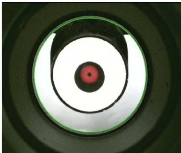
Blenden Sie den grünen Kreis ein (mit der entsprechenden Checkbox). Passen Sie die Größe des Kreises so an, dass er dem inneren Durchmesser des Okularauszugs oder Komakorrektors entspricht.
