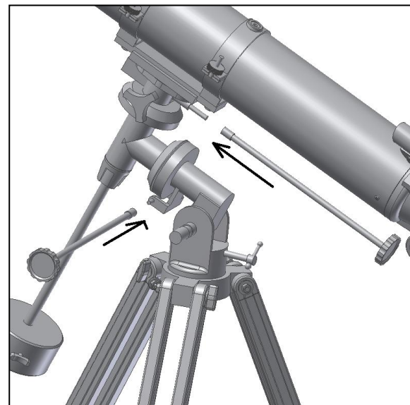
Fig. 7. Montaje de los ejes flexibles, de declinación y de ascensión recta.
