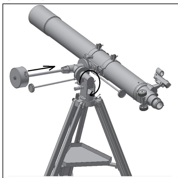
Fig. 10. Equilibrado del tubo (eje de ascensión recta).
