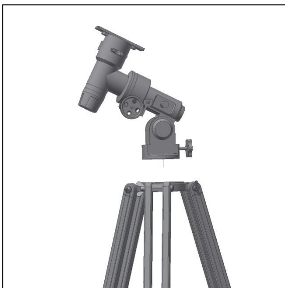
Figura 4. Colocar a cabeça equatorial no topo do tripé
