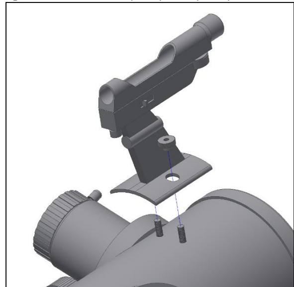
Figura 11. Colocar o buscador e aperte com as porcas
