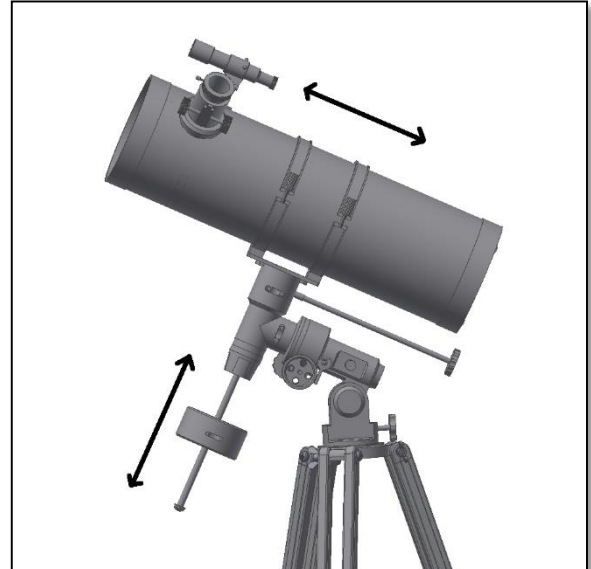
Figura 13. Balanceie o telescópio em ambos os eixos
